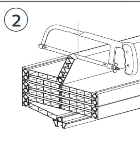
Kürzen Sie das Lamellenpaket von **UNTEN** mittels einer feinen Metallsäge auf das in Punkt 1 ermittelte Maß.
