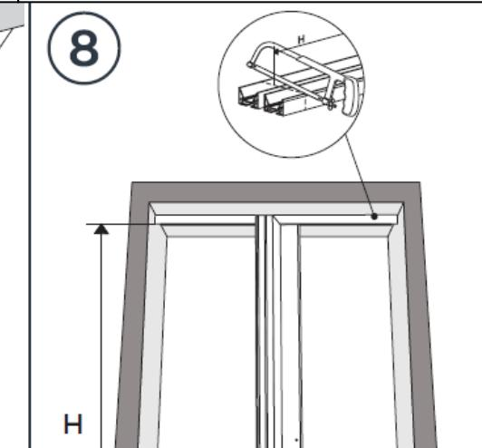
Ermitteln Sie nun die Höhe von Unterkante Laufschiene bis Boden und kürzen Sie die Wandprofile B auf das ermittelte Maß
