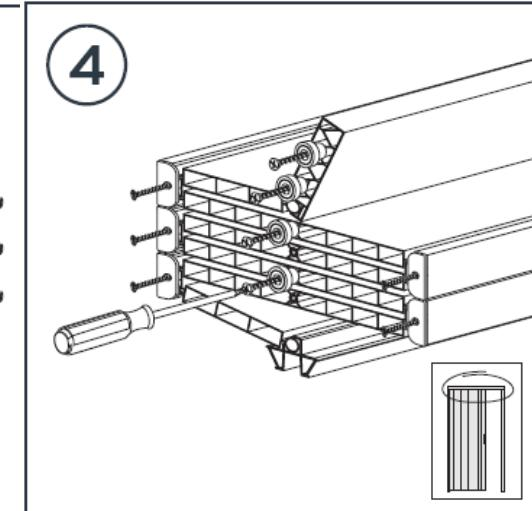
Anschließend montieren Sie **OBEN** ebenfalls Gleiter I in Profil F mittels Schraube 3,0x13 mm
