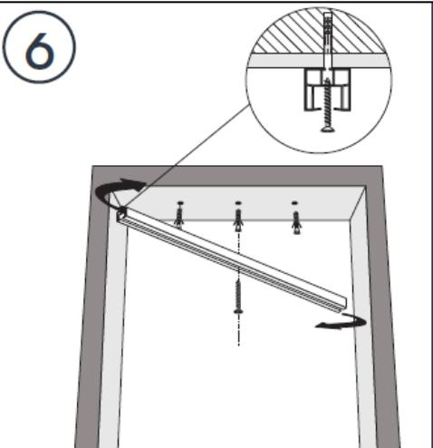
Befestigen Sie die Laufschiene nur mit einer Schraube mittig, damit Sie diese noch drehen können.
