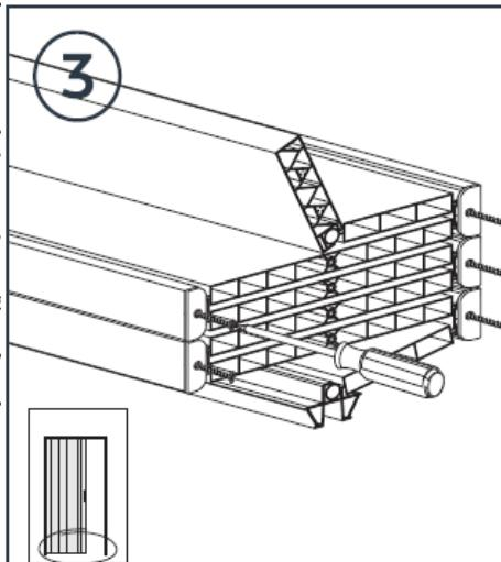
Montieren Sie unten die Gleiter I **UNTEN** in den Profilen F mittels den Schrauben 3,0x13 mm
