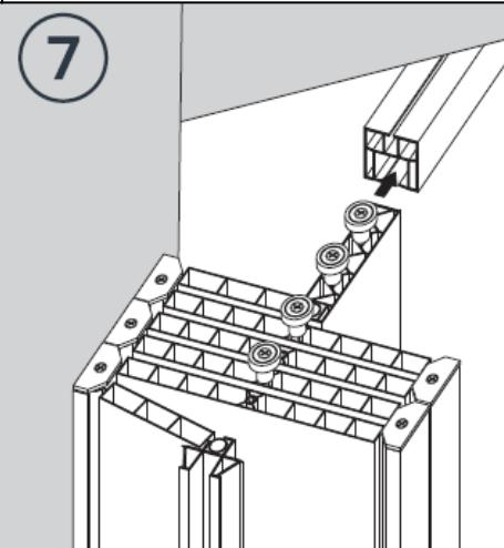
Drehen Sie die Laufschiene nach außen und schieben Sie die komplette Tür in die Laufschiene
